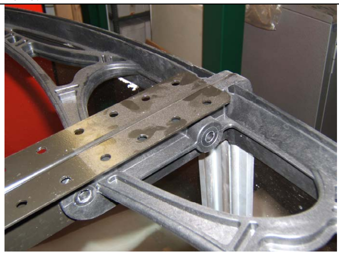
Fig.12: Posizionamento delle staffe di unione
