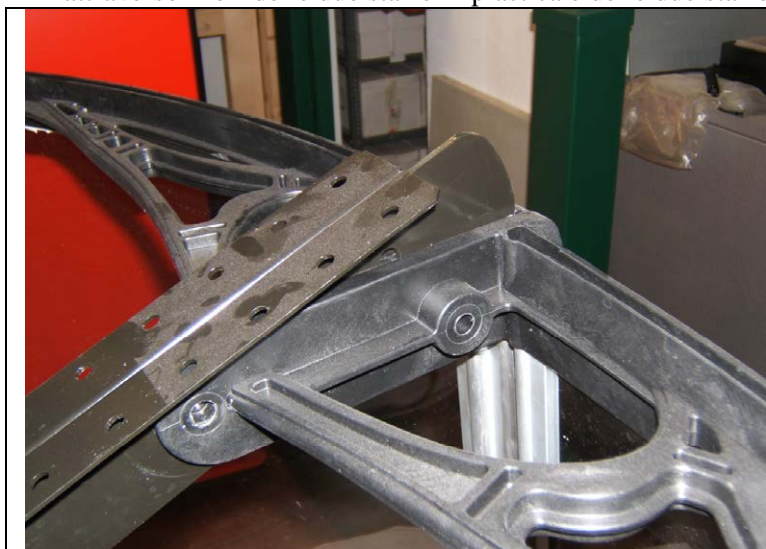
Fig.11: Inserimento delle staffe di unione
